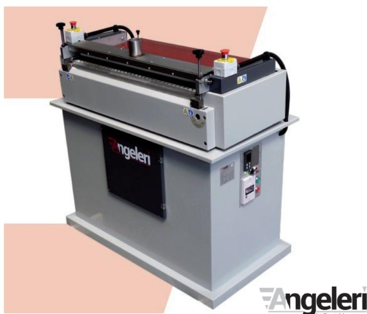
La gama de sistemas de termoencolado TH de Angeleri permite la aplicación de adhesivo termoplástico (hot melt) mediante un rodillo esparcidor. La cantidad de adhesivo se ajusta y distribuye con precisión gracias a una escobilla de goma, la cual transfiere proporcionalmente el adhesivo sobre el rodillo. La superficie de trabajo presenta una guía ajustable para regular la anchura de encolado. Tanto el espesor como la presión a ejercer sobre el material son regulables.
